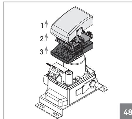
**01** • Afloje los tornillos y retire la tapa del motor, como se explica en la p. 05B.
