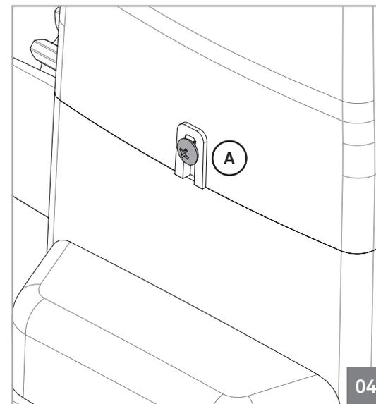
Durante la instalación hay que abrir la tapa del motor, para acceder a diversos componentes internos. Para ello, afloje un poco los 2 tornillos identificados con (A) hasta que la TAPA quede libre para ser retirada.
