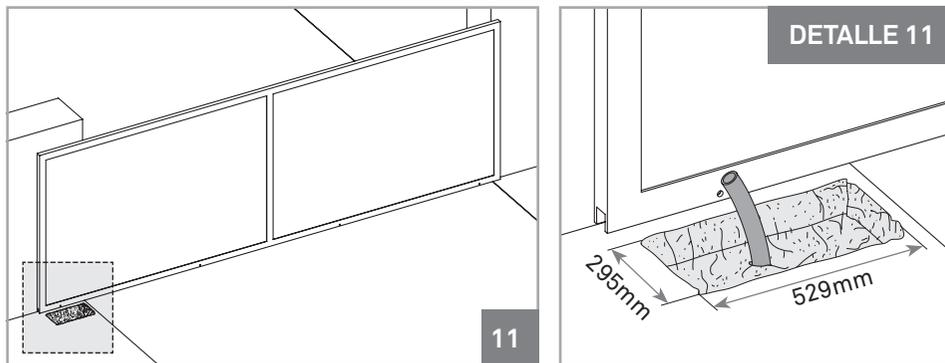
01 • Hacer un agujero en el suelo para crear un zapato en el hormigón. Las dimensiones que se muestran son los recomendados en la creación de la zapata. Los tubos deben quedar en el centro del agujero para el paso de cables y accesorios, como se muestra en la imagen 11.
