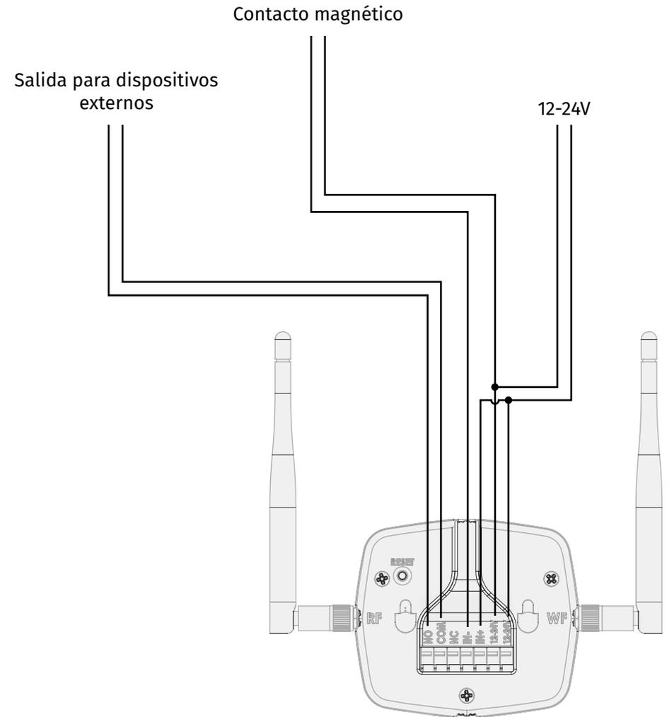
**Nota** • Si el dispositivo está conectado con USB, para usar la entrada, use una fuente externa de 12/24V.
